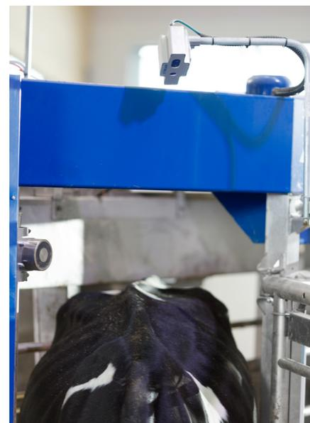
La caméra BCS de DeLaval est positionnée à la sortie d'un robot ou d'une salle de traite.
