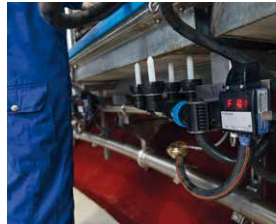
Geschützte Montage des ICAR anerkannte Milchmengenmessgerätes MM27BC mit integrierter Leitfähigkeitsmessung unter der Plattform
