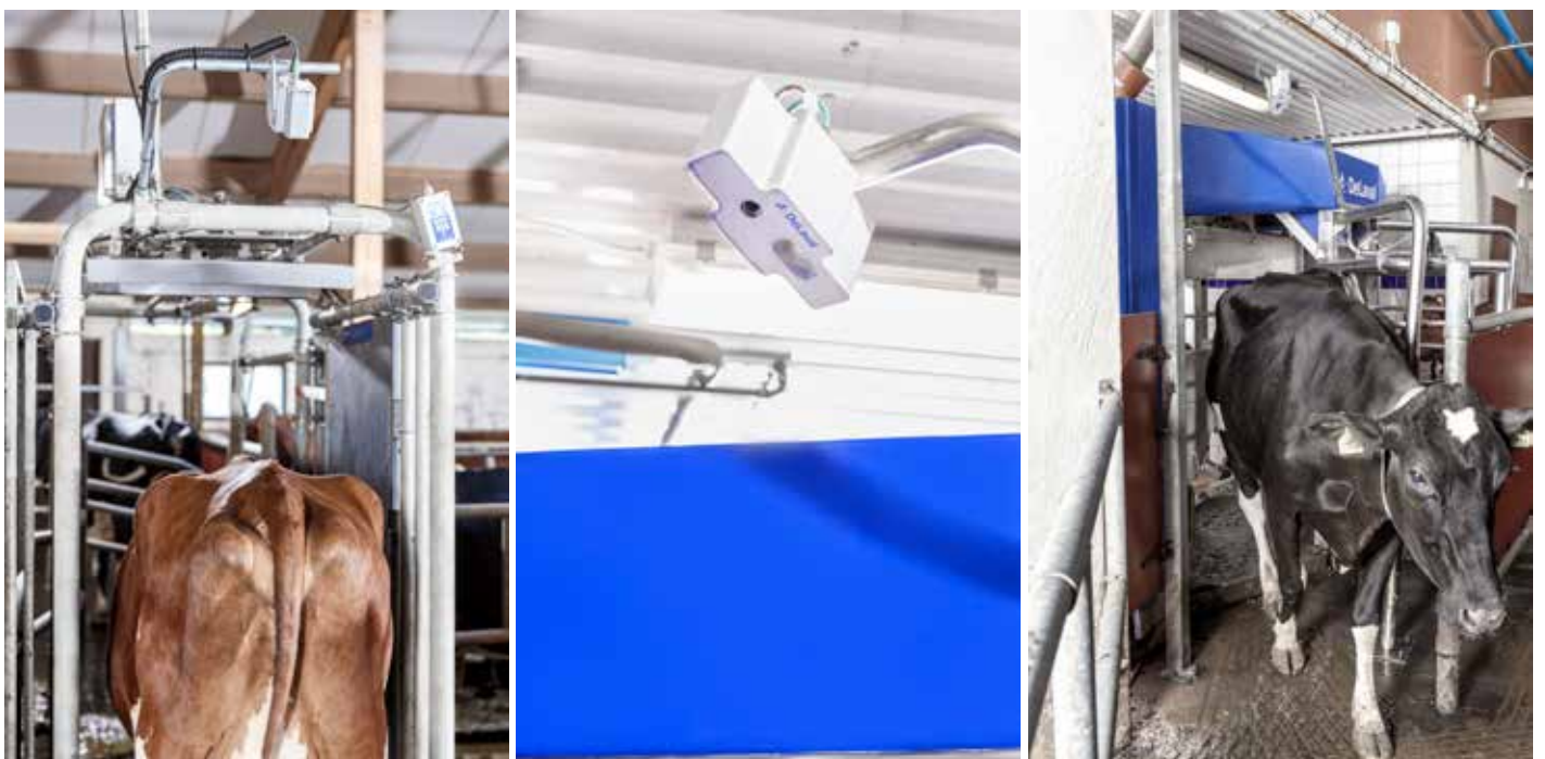
Die Position der BCS-Kamera am DeLaval Smart Gate oder am DeLaval VMS-Ausgangstor. Zusätzlich dazu kann sie am DeLaval Selektionstor installiert werden.
