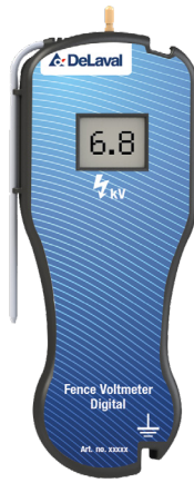
DeLaval digitaalne voltmeeter Digitaalne voltmeeter. Käepärane mõõteriist elektrikarjuse pinge mõõtmiseks. Digitaalne näidik, kV. 9 V patarei kuulub komplekti. Tootenumber 64164301
