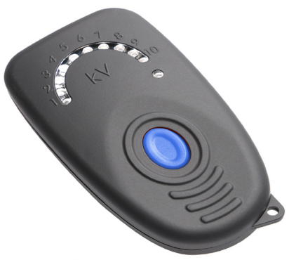
DeLaval karjusetester FT10 Näitab aia pingetaset 10-astmelisel LED-ekraanil, kuni 10 000 volti. Lihtne kasutada, ei ole vaja maandusühendust. Kaasas 2 x CR2016 3V patareid. Tootenumber 2150025169
