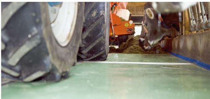
Son brevet unique BI-Orientation® fait du rouleau PVC de rénovation DeLaval une solution trois fois plus résistante que d'autres surfaces PVC. Le rouleau FTC DeLaval supporte la charge lourde d'un tracteur, d'un wagon d'alimentation ou d'un OptiDuo™. Il peut être installé sur n'importe quelle surface plane, la pose est rapide et la distribution possible aussitôt après.
