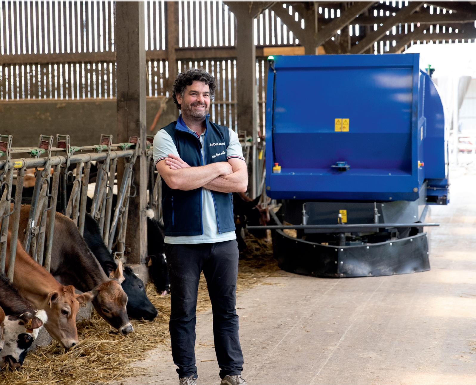
**Der DeLaval OptiWagon™ leistet Präzisionsarbeit. Geführt von einem Induktionskabel füttert er präzise und gewichtsgesteuert und schiebt dabei gleichzeitig das Futter an.**
