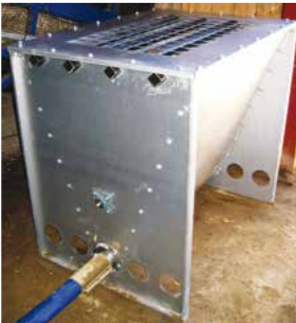
Mineralstoffdosierer OMD380 mit zusätzlichem Paddel zum Zerschlagen eventueller Futterbrücken.
