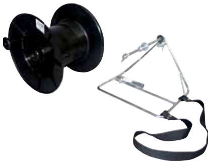
Combihaspel Lichtgewicht haspel. Voor het opzetten en afbreken van semipermanente afrastering. Geschikt voor ong. 4.000 m polydraad en ong. 1.500 m lint. Uitgevoerd met een robuuste rem. 85030005 Haspel 85030006 Beugel
