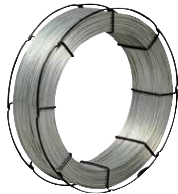
Voorgerekt draad, driefoudig gegalvaniseerd De voorgerekte staaldraden geven dit draad een extreem hoge treksterkte. Het is driefoudig verzinkt met tot 400 g zink/m². Bij normaal gebruik heeft dit draad een levensduur van meer dan 20 jaar.
