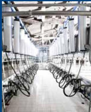
Das Haftvakuum im Zitzengummikopf kann so auf einem niedrigen Niveau gehalten werden, wodurch ein vorzeitiges Klettern der Melkzeuge vermieden werden kann – entsprechend gering ist das Nachgemelk und die Belastung des Zitzengewebes.
