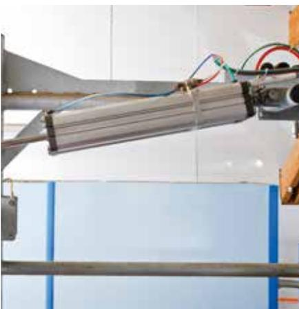
Doppelter Zylinder für Frontausgang und Indexing
