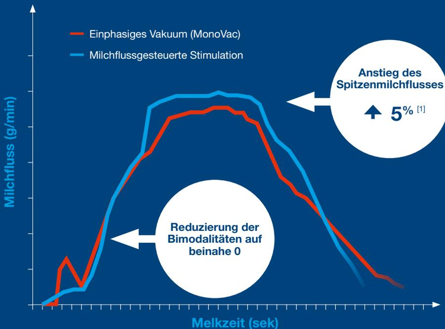
**i** Während der Stimulationsphase beträgt das angelegte Vakuum nur 34 kPa, Puls 30/70 mit 50 bpm. Die Hauptphase liegt bei 42–44 kPa, Puls 65/35 und 60 bpm. Der Abnahmeschwellenwert liegt zwischen 300–1.000 g/min.
