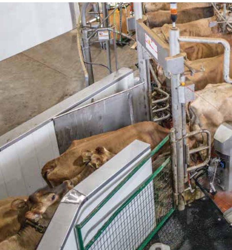
Dans nos systèmes les plus efficaces, la clé d'une entrée plus rapide réside dans la conception du couloir d'entrée. S'il n'est pas conçu correctement, le couloir d'entrée peut agir comme un goulot d'étranglement qui diminue la vitesse de chargement et entraîne plus de postes vides sur la plate-forme.
