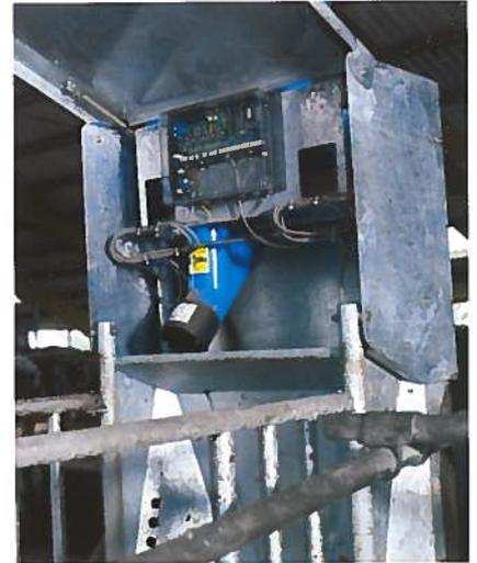
zeichnen sich durch eine servicefreundliche Bauweise aus. Über einen hochklappbaren Servicedeckel sind die Steuerung und die Dosierer leicht zugänglich und trotzdem geschützt.
