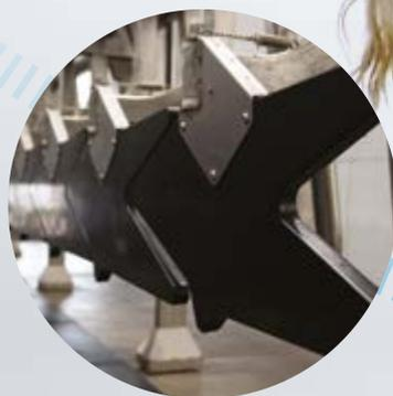
DeLaval SynchroSweep™ offre un processus de traite plus silencieux en raison de la conception derrière les portes de séquence qui ne se chevauchent pas.
