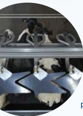
Le processus de Sortie par Section (Gang-Exit) permet à de plus petits groupes de vaches de quitter la salle de traite.
