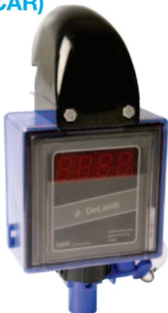
Il lattometro DeLaval MM25 SG, grazie alla sua tecnologia all'infrarosso, consente il controllo della produzione individuale di pecore e capre. Sul display del lattometro sono visualizzate la produzione, il flusso istantaneo di latte e la durata della mungitura.
