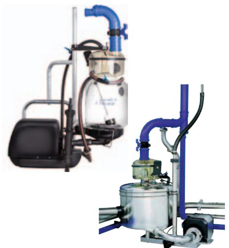
**I terminali di vetro** per la raccolta latte, **della serie GR DeLaval**, sono progettati per mantenere una perfetta igiene e sono adatti per impianti di piccole e medie dimensioni.
