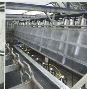
Het lexaan is doorzichtig zodat er nog een beetje zicht is op de koeien
