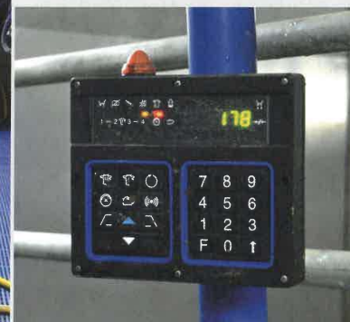
Met een bedieningskast voorin de melkstal kunnen koeien eenvoudig worden gesepareerd. Dit kan overigens ook via de computer.
