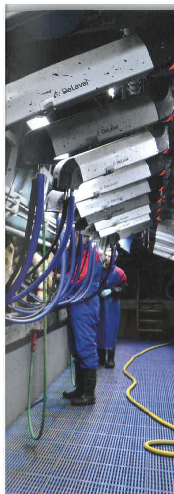
Het leidingwerk van de melkstal is weggewerkt in de kelder. Daardoor is de melkstal eenvoudig schoon te maken en is het er ook relatief stil.
