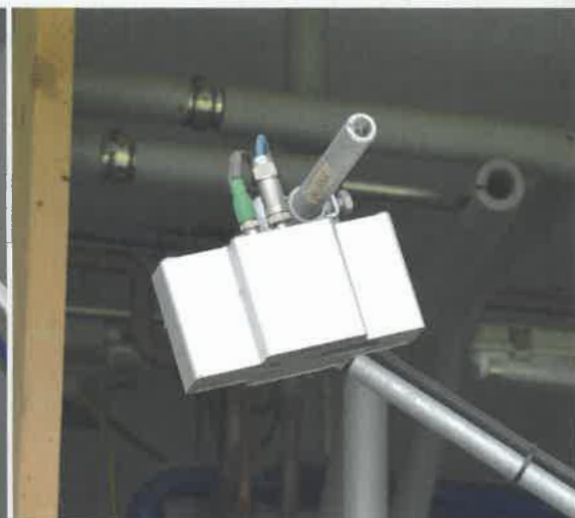
De camera wordt met behulp van een beugel aan de uitgang van de melkrobot of melkstal bevestigd.
