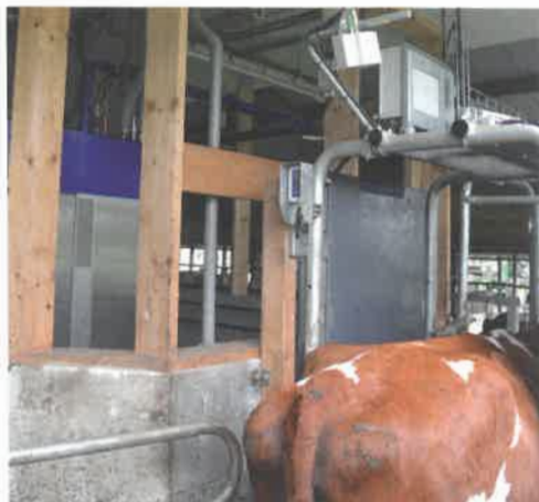
Montage op selectiepoort is mogelijk, maar raadt DeLaval af. Doordat de koeien stilstaan is de nauwkeurigheid minder hoog.
