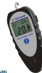
Gjerdetester multi Digitalt voltmeter med feilsøkingsfunksjon. Måler spenningsnivået og strømpå gjerdet. Viser med pil korteste veien til feil/kortslutning. Gjerdetesteren arbeider uten jordkabel. Inkl. 9V batteri. 85030001 1.705,- (2.131,-)
