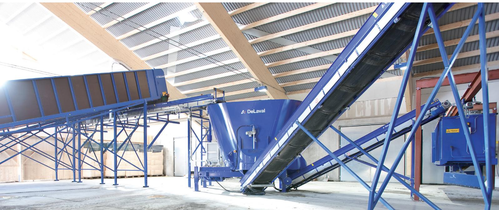
Le système Optimat™ est basé sur un réseau de rapports spécifiques pour chaque étape de travail. Une mélangeuse fixe verticale robuste mélange tous les composants devant être chargés jusqu'aux balles rondes. Un moteur avec variateur de vitesse garantit que seule la puissance qui est réellement requise est utilisée.
