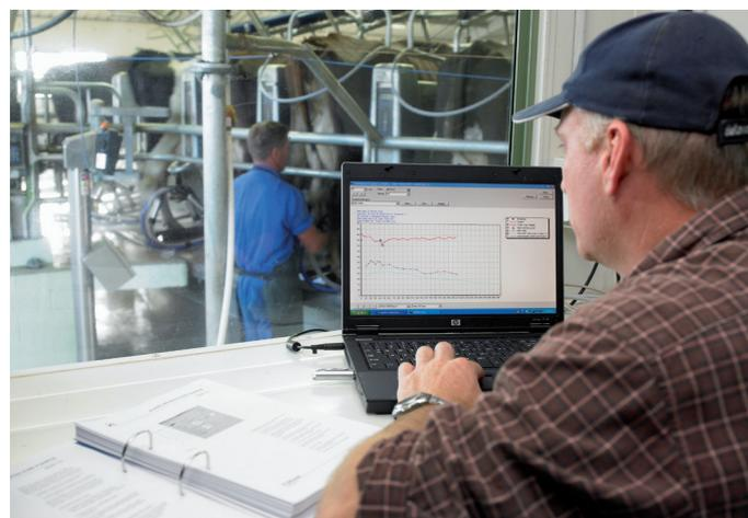
Avec le système de pesage en continu AWS100 DeLaval, les vaches peuvent être pesées sur le chemin de retour de la salle de traite ou du roto après chaque traite (jusqu'à quatre fois par jour), chaque jour. Le poids moyen sur sept jours est ensuite calculé par le système et différentes comparaisons dans le temps indiquent les variations de poids de l'animal.
