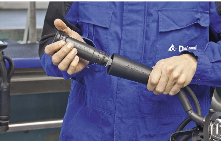
Le clou de cette unité de traite consiste en l’échange rapide de la cartouche, un gain de temps considérable.
