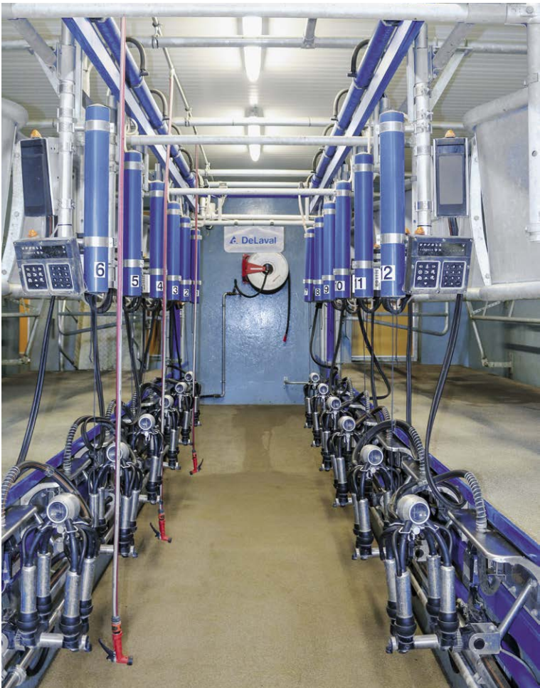
Équipée du système de dépose automatique des faisceaux trayeurs MPC680 et de l'unité de traite MC73, la salle de traite offre confort aux vaches et au trayeur.
