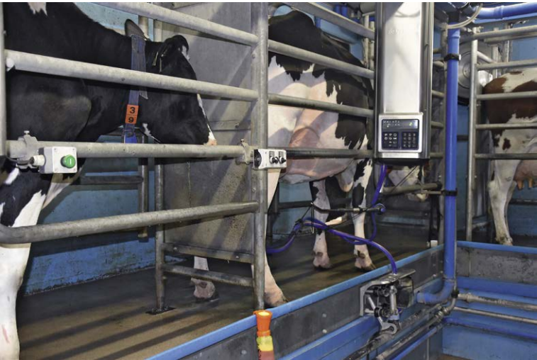
Lionel Kolly traite ses vaches dans une salle de traite Tandem U5 équipée d’une desserte de postes de traite MP780. Elle protège les composants importants pour la traite de l’humidité et de la poussière.
