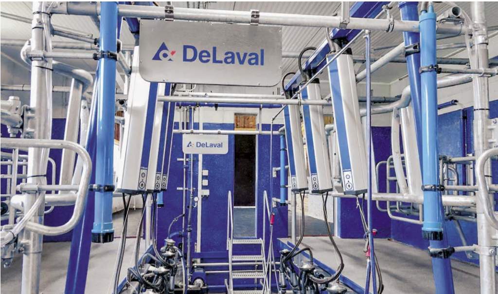
DeLaval a fourni l'entier de l'équipement de ferme. La salle de traite en épi 50° 2 x 3 est équipée d'un décrochage automatique et des nouveaux faisceaux trayeurs Evanza.
