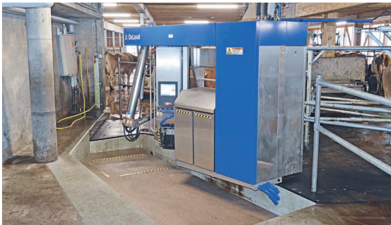
Le VMS V310, le bureau et le local technique ont pu être installés dans l'espace intérieur existant, résistant aux frimas hivernaux. La petite fosse située devant le robot de traite aide les agriculteurs dans leurs tâches quotidiennes.
