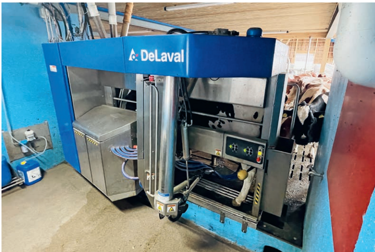
Roboter Bild: Der VMS V310 mit Progesteron- und Zellzahlmessung arbeitet schnell, leise und zuverlässig.
