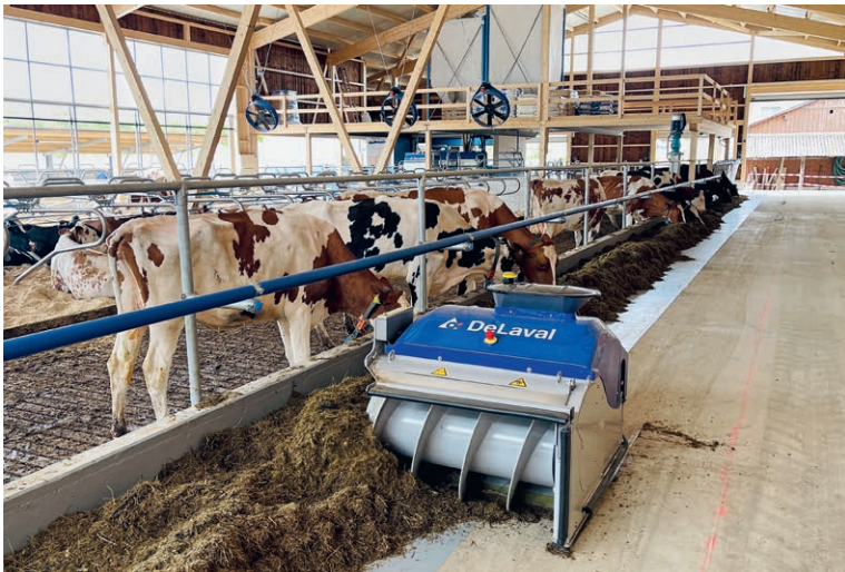
Der OptiDuo schiebt das Futter an und lockert es gleichzeitig auf.
