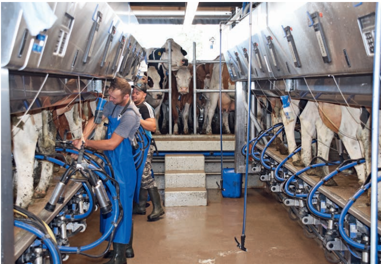
Der Parallel Melkstand ist ein effizienter Melkstand. Kurze Wege für Melker und Kühe.
