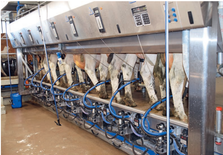
Die Kühe stehen im 90°-Winkel zum Melker.
