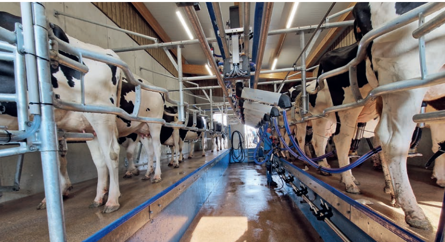
Im modernen Melkstand haben 16 Kühe Platz. Sie werden mit 8 Melkzeugen, die in der Mitte installiert sind, rechts und links gemolken. Der Melkstand kann noch um zwei Plätze erweitert werden.
