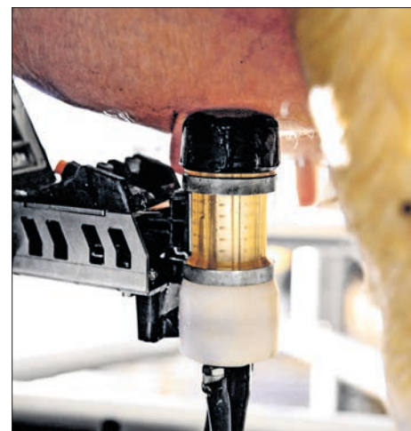
DeLaval PureFlow™ – reinigt die Zitzen nicht nur, sondern bereitet sie vor dank einem neuen, leistungsfähigen Vorbereitungsbecher.
